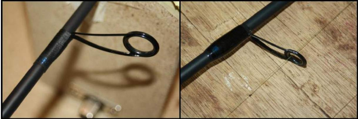
Voici l'alignement des anneaux une fois la canne finie et le haut du porte moulinet. Le wrapping n'est pas directement au dessus du porte moulinet mais trois centimètres au-dessus pour avoir les doigts directement sur le blank de la canne en action de pêche toujours dans le soucis d'optimiser la perception des touches.
